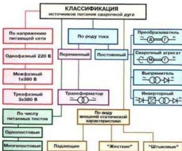
Рисунок 3.1 – Классификация источников питания сварочной дуги
